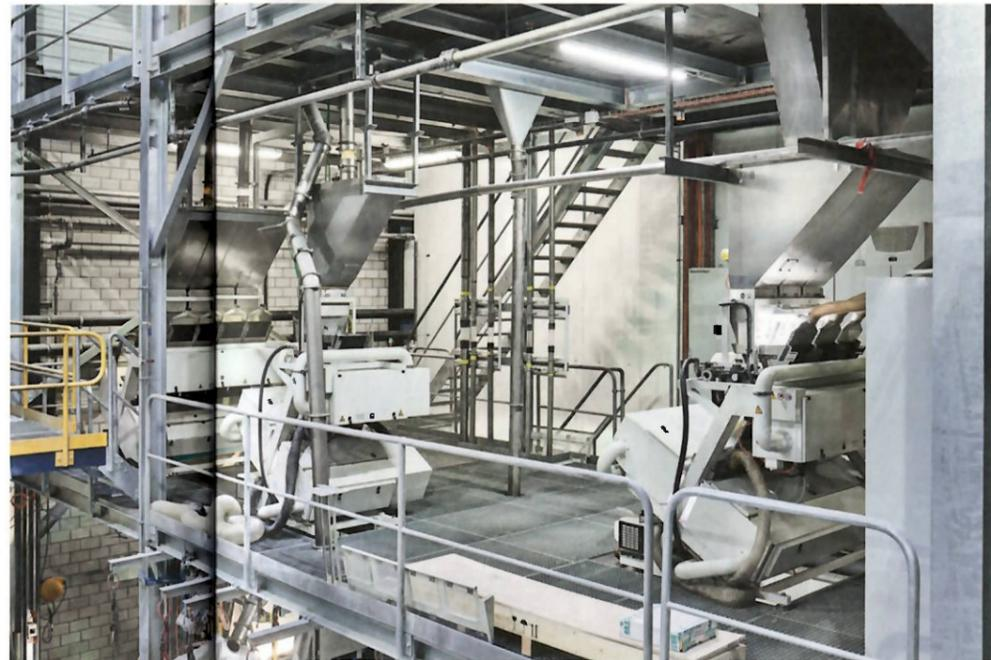
Der «Flakesortier» überprüft mit modernsten Sensoren jedes einzelne PET-Flake auf seine Qualität.
